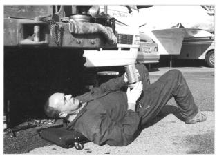
Neuer Oelfilter wird eingesetzt
