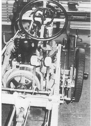
Am kleinen Rad in der Mitte des Steuerrades, sind als Bedienungs-Hebel Zündverstellung und Handgas.
