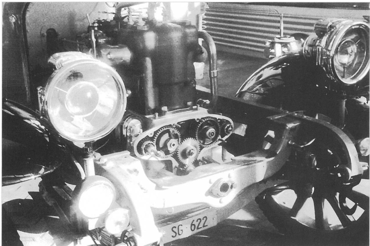
Der Motor mit offenem Nockenwellen Antrieb.
