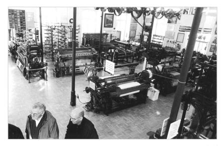
Im Erdgeschoss finden wir eine vielfältige Auswahl von Textil-Maschinen, mit Transmissionen an der Decke zum Antrieb.
