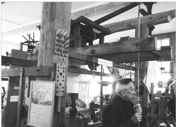
Diese Holz-Jacquardmaschine (Xaver Stoffel, Arbon, Baujahr 1860) ist aufgebaut auf einem Handwebstuhl. Dieser Webstuhl mit Jacquardmaschine ist ein typischer Zeuge jener Zeit. Hochkomplexe Konstruktionen aus Holz dienten zur Herstellung edelster Gewebe. Der Antrieb und der Schusseintrag erfolgten durch Muskelkraft, die Musterung durch eine Lochkarte, welche nach jedem Schuss von Hand weitergeschaltet und dabei eingelesen wurde.
