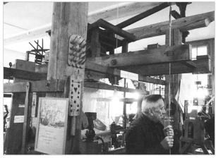
Diese Holz-Jacquardmaschine (Xaver Stoffel, Arbon, Baujahr 1860) ist aufgebaut auf einem Handwebstuhl. Dieser Webstuhl mit Jacquardmaschine ist ein typischer Zeuge jener Zeit. Hochkomplexe Konstruktionen aus Holz dienten zur Herstellung edelster Gewebe. Der Antrieb und der Schusseintrag erfolgten durch Muskelkraft, die Musterung durch eine Lochkarte, welche nach jedem Schuss von Hand weitergeschaltet und dabei eingelesen wurde.
