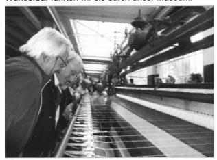
Aufmerksam verfolgen die Kollegen von Sulzer-Rüti den Arbeitsgang auf der Saurer-Handstickmaschine. Die 52 Nadeln sind auf einem Wagen aufgereiht, welcher mit Muskelkraft bewegt wird. Die 2cm langen Nadeln haben 2 Spitzen und eine Öse in der Mitte. Sobald sie durchs Gewebe geschoben sind, werden sie auf der hinteren Seite von den Klüpperli eines zweiten Wagens erfasst und durchgezogen.
