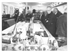
Die Projektilwebmaschine von Sulzer (im Markt seit 1955). Der
