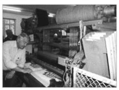
hand einer grossen Zahl von Webstühlen und Webmaschinen einen Einblick in die Entwicklung und Funktion verschiedener Systeme. Es werden hier nämlich alle bekannten Webverfahren präsentiert: Schussfadeneintrag mit Webschützen (Schiffli), mit Projektil, mit Greiferstäben, mit Wasser- oder Luftdüsen, sowie Wellenfach und Reihenfach.
