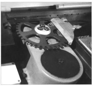
Ein 2.5m langer Greiferstab wird von einem Zahnrad in der Maschinenmitte angetrieben. Er bewegt sich abwechselnd nach links und nach rechts, nimmt an seiner Spitze jeweils den Schussfaden auf und bringt ihn durch das Webfach.
