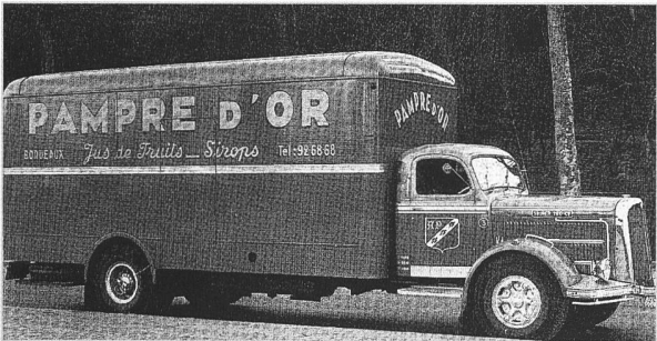
5DCS mit Kastenaufbau 10.2t Nutzlast bei 19t GGW.
