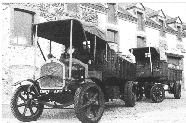
Saurer Baujahr 1911 mit Saurer-Anhänger. Der Anhänger hatte ein Bremserhäuschen wo ein Bremser postiert war. Das Fahrzeug steht im Musée du Poids Lourds in Mondoubleau.
