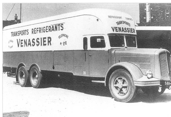
Ein wuchtiger 8BSUD Kühlwagen mit einem Leergewicht von 11 Tonnen und einer Nutzlast von 15 Tonnen.
