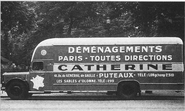
Ein Möbelaufbau 37 m 3 von Pelpel auf 3CT1D. Verchromte Kühler gab es damals in Frankreich nur bei Saurer.
