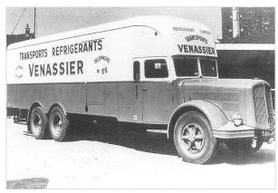
Ein wuchtiger 8BSUD Kühlwagen mit einem Leergewicht von 11 Tonnen und einer Nutzlast von 15 Tonnen.
