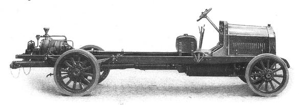
Feuerspritzen-Chassis mit Zentrifugalpumpe (Pumpe System Sulzer)
