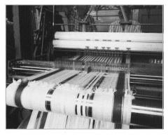
Nach dem Knüpfvorgang wurde die Knüpfmaschine und das Knüpfgatter entfernt und die Kettfäden angespannt.
