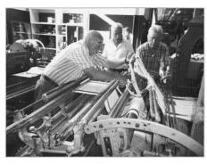
behilflich zu sein. Am 31. August war es dann soweit. Die neue Kette wurde in die Kettbaumlagerung eingelegt und Herr Schafroth klemmte die 1048 Kettfäden geordnet mittels eines Fadenkreuz (auch Rispe genannt) auf das Knüpfgestell.
