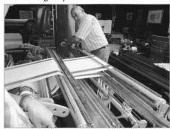
falls sauber geordnet direkt über den Kettfäden der neuen Kette aufgespannt und geklemmt. Nun kam die Knüpfmaschine zum Einsatz. Faden um Faden liest sie aus Fadem denkreuz. Mittels
