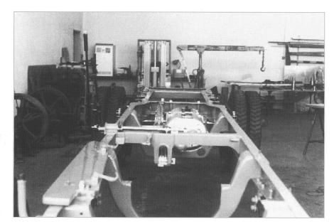
Montiert sind am Chassis Hinterachse mit Räder. Getriebe mit Schaltung
