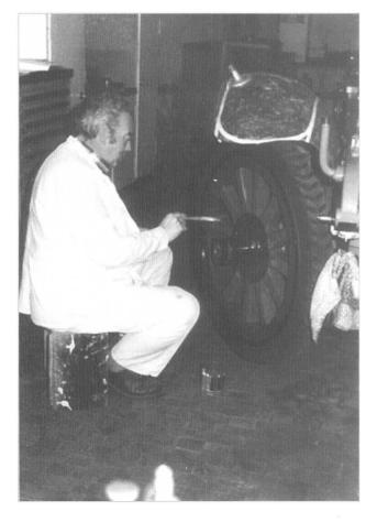
Vor dem Zusammenbau wird allen rohen Teilen, mit einem Farbanstrich ein dauerhaften Schutz vor den Witterungseinflüssen verliehen. Wobei der Farbton, möglichst der Zeit, der ersten Inbetriebnahme des Fahrzeuges angepasst wurde.
