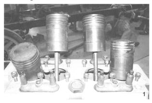
Zylinder waren zu honen, an den Kolben war einzig ein Kolbenring zu ersetzen. Dieser fehlte, wurde wohl bei einer früheren Revision einfach "vergessen". Bild
