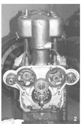
2 zeigt den zusammengebauten Motor von vorne. Die Zahnräder sind original, zu ersetzen waren die Kugellager. Erstaunlich, dass auch heute, hundert Jahre später, Kugellager in den gleichen Abmessungen noch lagerhaltig sind. Kompliment an die damaligen Konstrukteure, sie setzten Weltstandards.
