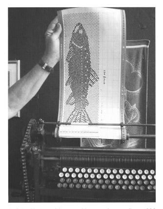
Auf der Kartenschlagmaschine wurde nun dieser 230 schussfadenlange Rapport geschlagen. Reihe um Reihe muss mittels der Tastatur, Nr. 1 bis Nr. 64, mit drücken der jeweiligen Taste bestimmt werden, ob der Kettfaden gehoben werden muss. Ein Loch in der Karte bedeutet Kettfaden gehoben. Dieser Rapport wurde dann sechsmal kopiert, also sechs Fische in jeder Bordüre. Am Anfang und am Ende des Tüechlis benötigten wir noch ein paar Hundert Schuss zum säumen.
