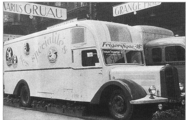
Kühlauflieger von David auf 3CT1D. Das Kühlaggregat ist oberhalb des Fahrerhauses in den Aufbau integriert
