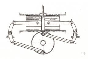
Schemazeichnung des Balancier-Gegenkolbenmotors
