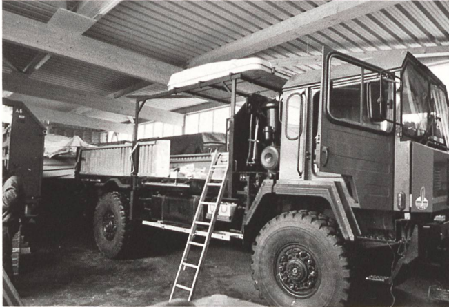
Der bewährte gekürzte Saurer 6DM, mit Rudi am Steuer. Verbessert mit besserer Navigations-Hardware, LED Lampen, Zusatztanks und nachgerüsteter vorderer Diff-Sperre
