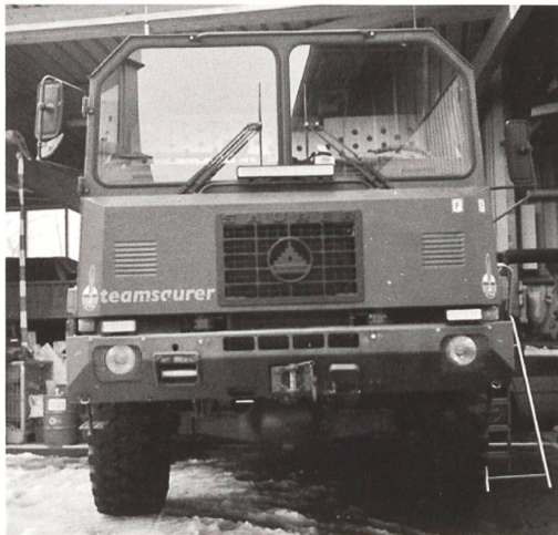
Camion Balais 2010: Der bewährte Saurer 6DM, dieses mal verbessert mit Zusatztank, LED Scheinwerfer, besserem Navi Laptop, Dachzelt und Hammelgalge
