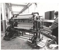
Schifflistickmaschine mit Schablonensteuerung (Stichscheibenautomat) beim Platzieren
