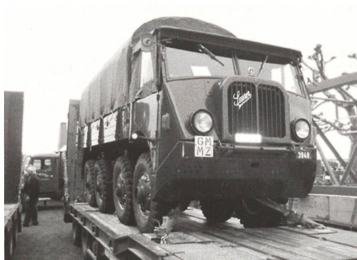
Das Militär lässt grüssen: Schwerer M8-Geländelastwagen mit Antrieb aller vier Pendelachsen.
