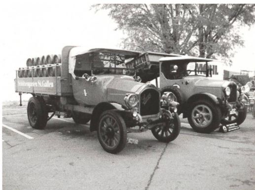
Saurer-A-Wagen mit Vollgummibereifung und Kettenantrieb von 1917; dahinter ein AD von 1925 mit Kippbrücke und GF-Simplex-Rädern.
