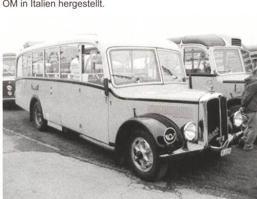
PTT-Alpenwagen Typ II der Saurer-Schwestermarke Berna mit CR2D-Motor und Aufbau der Kreuzlinger Carrosserie Seitz (später Mowag).
