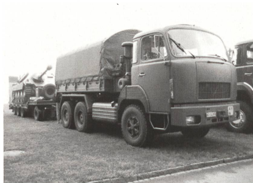
D-Typ-Frontlenker der Armee mit Jagdpanzer G13 (ausgerüstet mit Saurer-V8-Dieselmotor) auf Tieflader.
