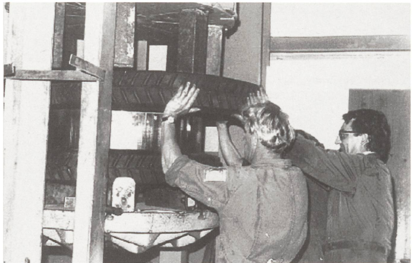
Der Vollgummireifen wird in der Presse aufgelegt.
