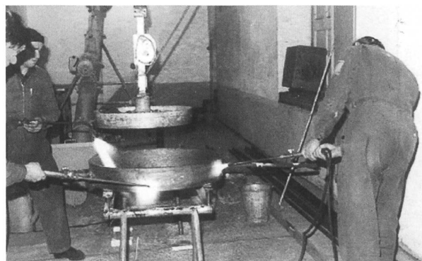
Die 12 mm dicken Flachstahl Radreifen wurden bei Meister gerundet, im Schuga verschweisst und vorbereitet zum Aufziehen. Wärmen des Radreifen für ein Vorderrad, darüber das zum Einfahren aufgehängte hölzerne Rad mit montierter Lagerbüchse.
