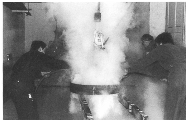
Nach dem Aufziehen wird der glühende Eisenreif mit viel Wasser gekühlt
