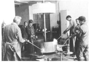
Die Vorderräder waren eigentlich problemlos zu bereifen. Die Hinterräder aber, erwiesen sich als eigentliche Knacknuss. Der 350 mm breite und 12 mm dicke Reif benötigte allerhand Wärme, um das Eisen rotwarm glühend zu bekommen. Zudem erforderte der breitere Reif eine ausreichend präzise Zentrierung, sowie eine rasche präzise Absenkung des Holzrades, um ein Verbrennen des Holzes, im Bereich des glühenden Eisens möglichst gering zu halten.
