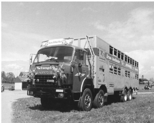
Saurer D330BF 8x4 mit 2-stöckigem Schweinetransporteraufbau, aufgebaut von Fuchs Malters.
