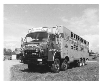
Saurer D330BF 8x4 mit 2-stöckigem Schweinetransporteraufbau, aufgebaut von Fuchs Malters.
