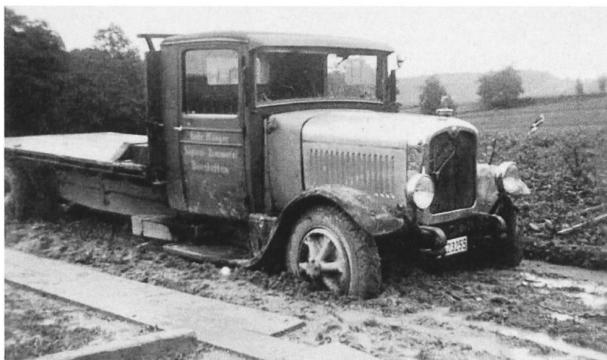
Ab 1950 wurden die Holztransporte durch Franz Niederberger aus Alpnach mit seinem Hürlimann D500 ausgeführt. Dieser Hürlimann war mit einem Motor Lizenz Saurer und Doppelseilwinde ausgerüstet, was das Beladen erheblich erleichterte.
