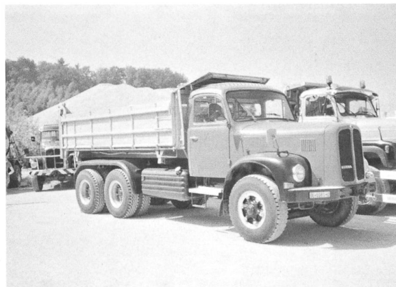
Heisses Eisen: ein seltener 3-Achser, Berna 5V 6x4 mit D1KL-Motor mit mechanischem Saurer-Schraubenradgebläse
