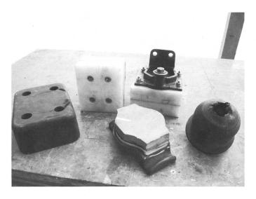
u.r: der Originalanschlag der Achsen, u.l: die Version 1, ein Massiv-Gummiklotz, die sofort wieder platzte dann die neueste Version der Anschläge unten mit Gummi belegt und oben POM Kunststoff
