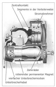
Scintilla-Magnetzünder für Ein- und Mehrzylindermotoren
