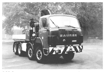
Saurer D 330 BF 8x4 Chassisnr. 212206 Motornr. 113723 Zugmaschine mit Brücke und Kran
