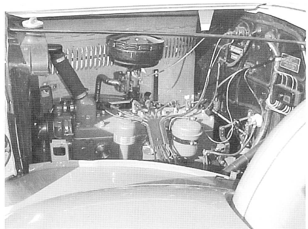
Bild rechts: Der wunderschöne gepflegte 2.7l 6 Zylinder Benziner, ein richtiger „Amerikaner“, montiert in der Schweiz.
