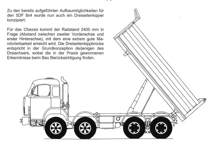
Die *Nutzlast* liegt bei ca. 16 t und entspricht somit derjenigen eines Anhängerzuges. Demzufolge wird der Inhalt der Kippbrücke 10 - 11 m³ betragen. Deren Innenlänge ist mit 5m festgelegt. Aufgrund dieser Konzeption wird noch eine günstige seitliche Einladehöhe er-
