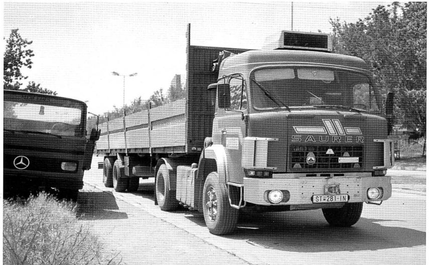
Immer noch täglich im Einsatz: Saurer D330B Sattelzug in Radoviš; umgebaut von der 3-Achs zur 2-Achs-Zugmaschine
