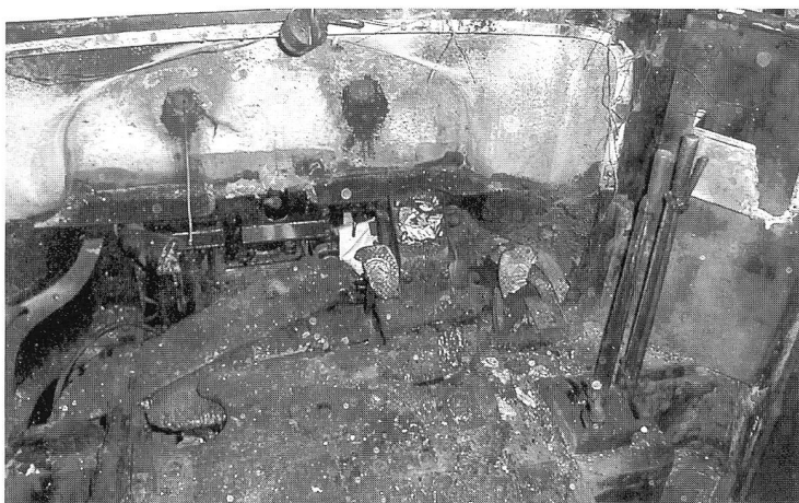
Der komplett zerstörte Führerstand
