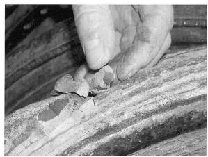
Detail eines "Caminhao"-Hinterrads: Die ursprüngliche Gummierung ist aus mehreren Schichten hergestellt. Das war damals unumgänglich, haftete doch der Kautschuk nur sehr schlecht direkt auf dem Eisenreifen. Deshalb ist der Reifen auch eingekerbt und rau. Heute muss man mit möglichst originalen Materialien die Vollgummis ganz anders konstruieren. Auch die klassische Pressung der zwei ineinander liegenden Eisenreifen kann man nicht nachahmen, dazu fehlen die kräftigen Riesenpressen von damals.
