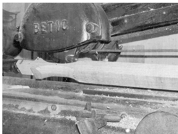
Die Speichenfräsmaschine Modell 1920 im Atelier Monpied am Werk: Es entsteht eine neue ovale Speiche aus Akazienholz für ein antikes „Automobile“
