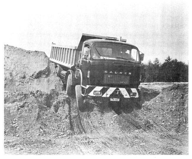
Bild 1 Ein Prototyp des 4-Achsers 5DF 8x4 wird mit voller Belastung über eine Marterstrecke gequält, um die Festigkeitsberechnungen zu überprüfen.
