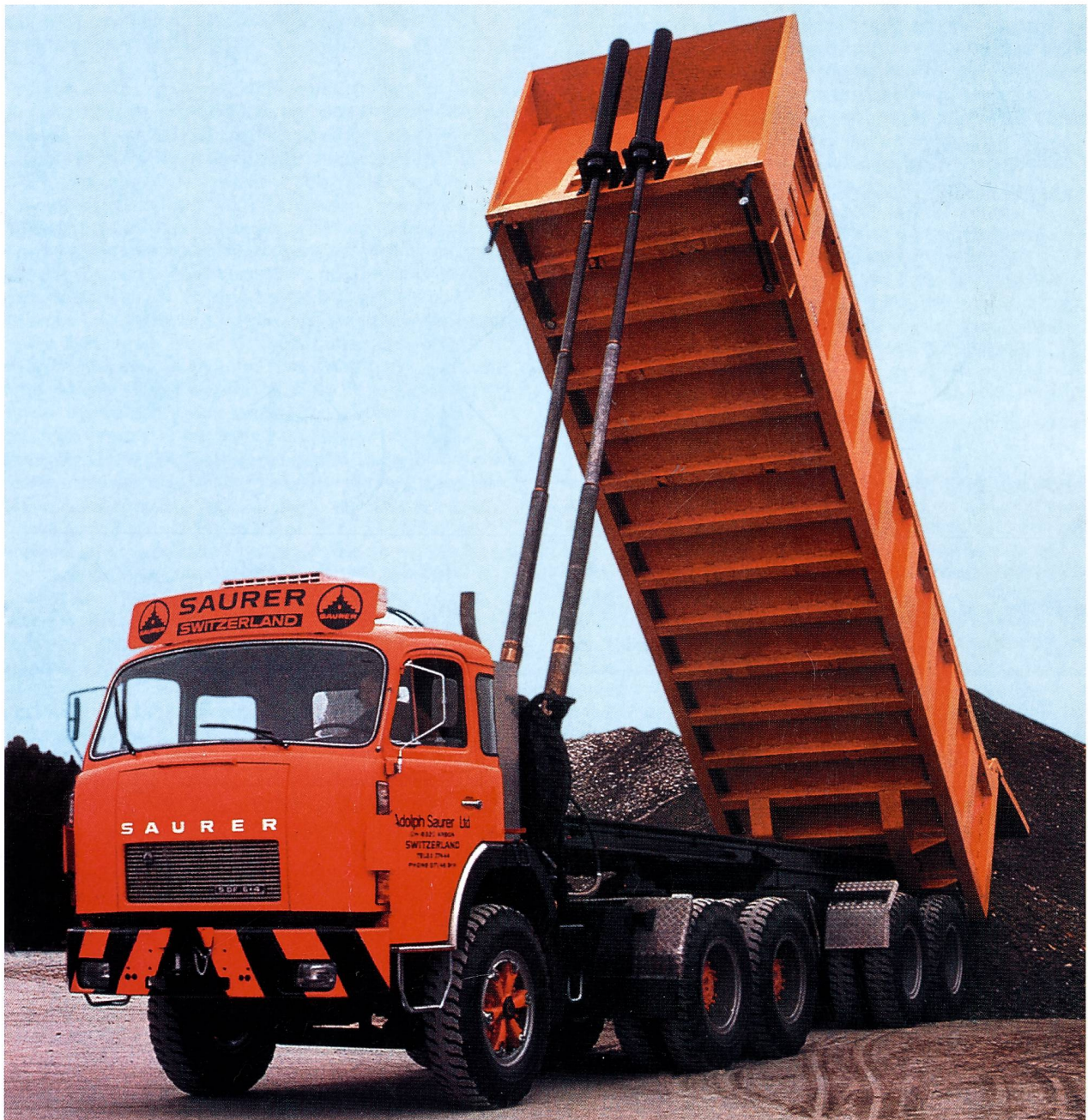
Export-Sattelschlepper SAURER 5DF 6x4, ausgestattet für den Einsatz unter harten Wüstenbedingungen im Mittleren und Nahen Osten. Das Gesamtgewicht der Zugmaschine mit dem 24m 3 -Kippmulden-Auflieger beträgt 60 t. (Über die Exportoffensive in den Nahen Osten wird in dieser Gazette berichtet)
