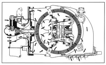
200-PS-Zweiwellenkleingasturbine von General Motors mit rotierendem Regenerativwärmetauscher für das Fahrzeug "Fire-Bird II"
