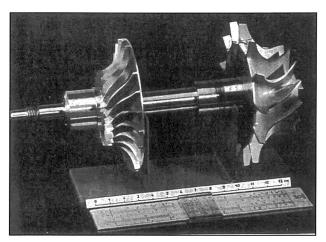
Turbinenwelle mit Turbinenrad rechts und Gebläserad links.
