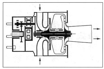
Schematischer Längsschnitt der GT 15
