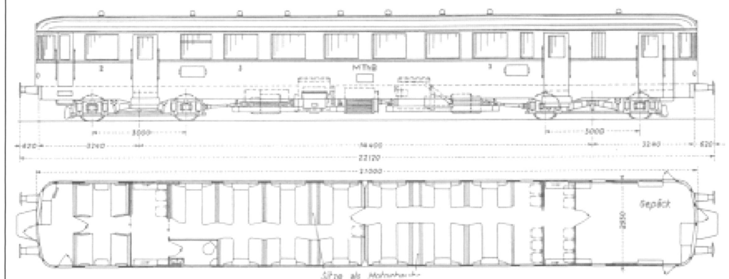
Abb. 1. 300 PS-Diesel-mechanischer Triebwagen der Mittelthurgau-Bahn
