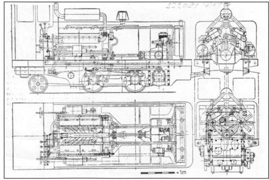
Saurer erhielt nun den Auftrag unter Berücksichtigung der einschlägigen Vorschriften des EAV die ersten dieselbetriebenen Zahnradlokomotiven (Bild) zu bauen. Zu diesem Zweck mussten zwei dieser niedlichen Dampflokomotiven das Leben lassen. Die Konstrukteure bei Saurer waren der Auffassung, dass, um Kosten zu sparen, der Rahmen der bestehenden Lokomotiven weiterhin zu verwenden sei.
