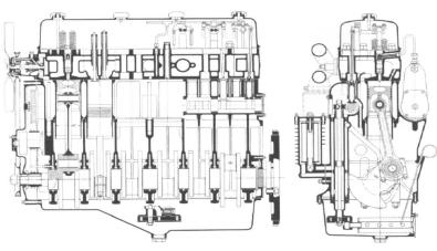
Längs- und Querschnitt des SAURER-Sechszylinder-Schnellläufers: Typ PD
