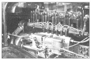
Vierventil-Kipphebelsteuerung und Spritzmomentregler des PD-Saurer-Diesel
