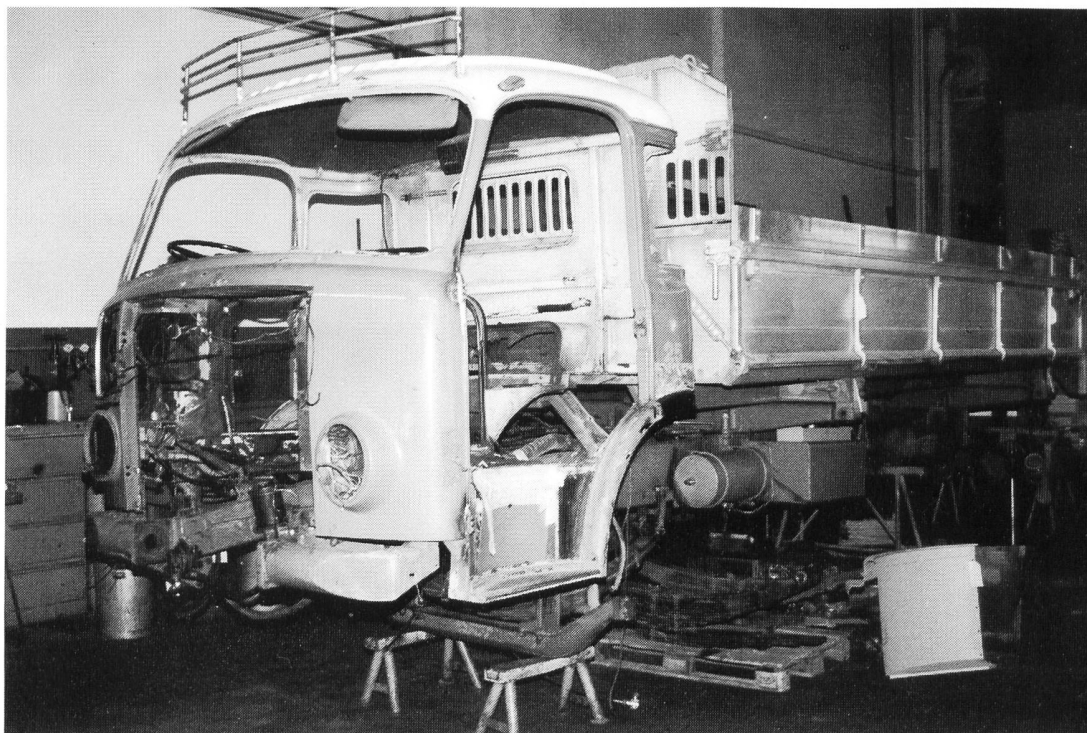
Motor und Achsen demontiert; die Kabine offenbart ihren Zustand
