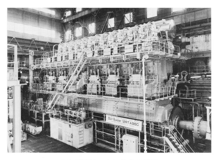
DU-Sulzer 12RT A96 C, der grösste je gebaute Sulzer-Diesel mit 90'000 PS
