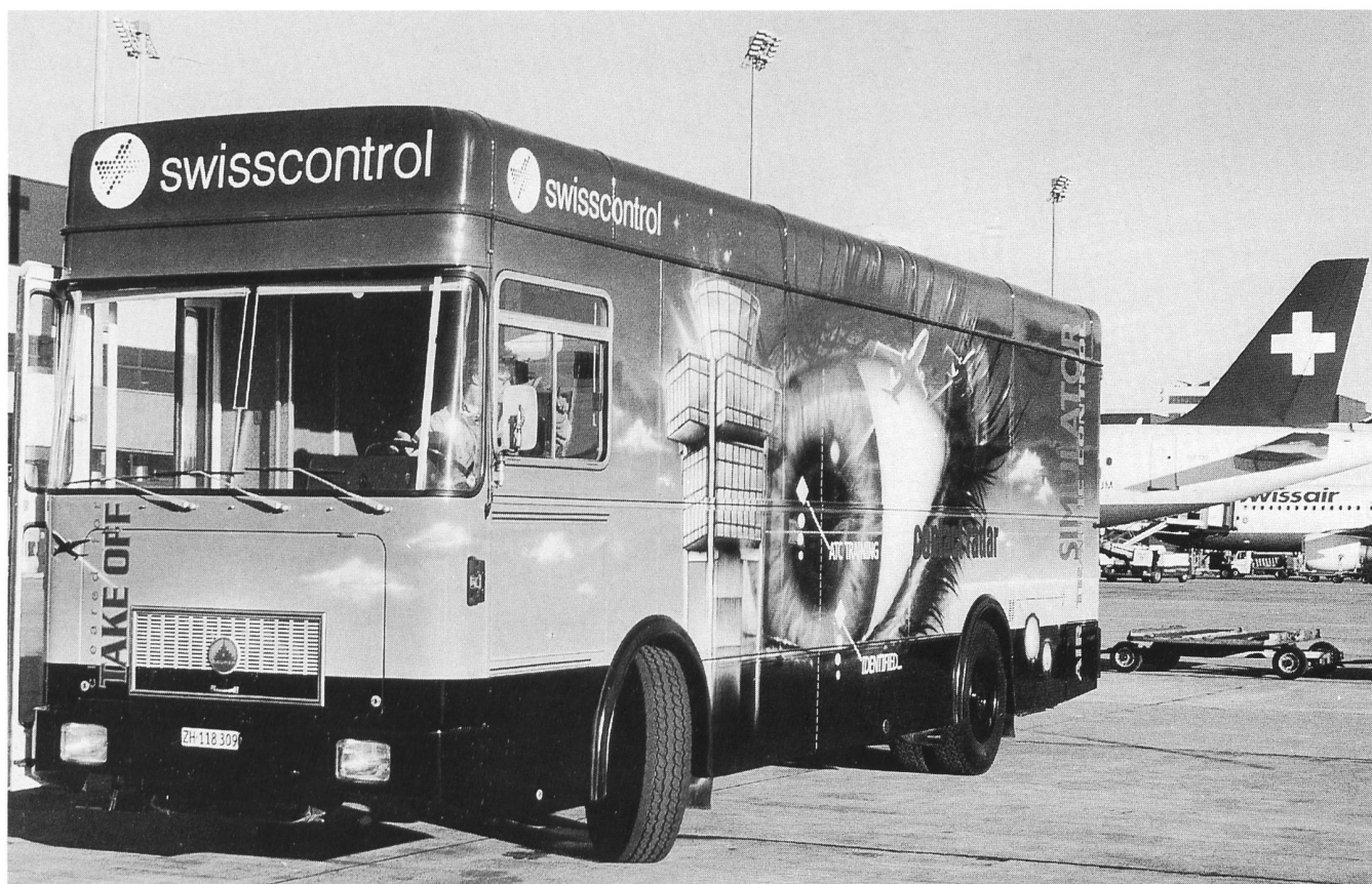
Chassis K500-23 mit mit D2KTU Unterflurmotor, 250 PS, und ZF-Automat HP400
