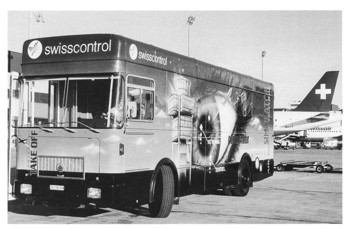
Chassis K500-23 mit mit D2KTU Unterflurmotor, 250 PS, und ZF-Automat HP400
