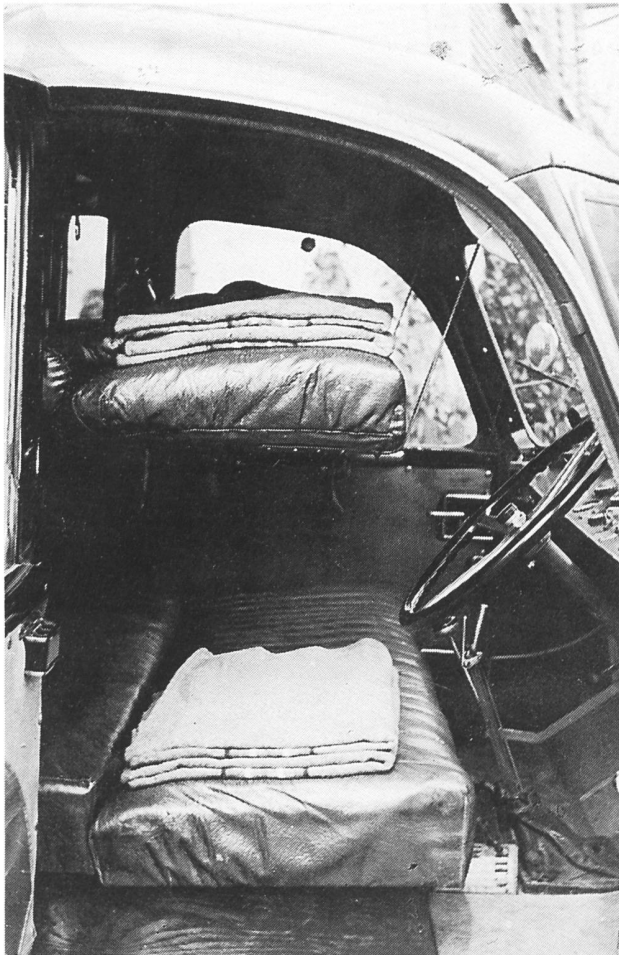
Die im Eigenbau zum Schlafen einer Zweier-Equipe umgerüstete 4C-Kabine
