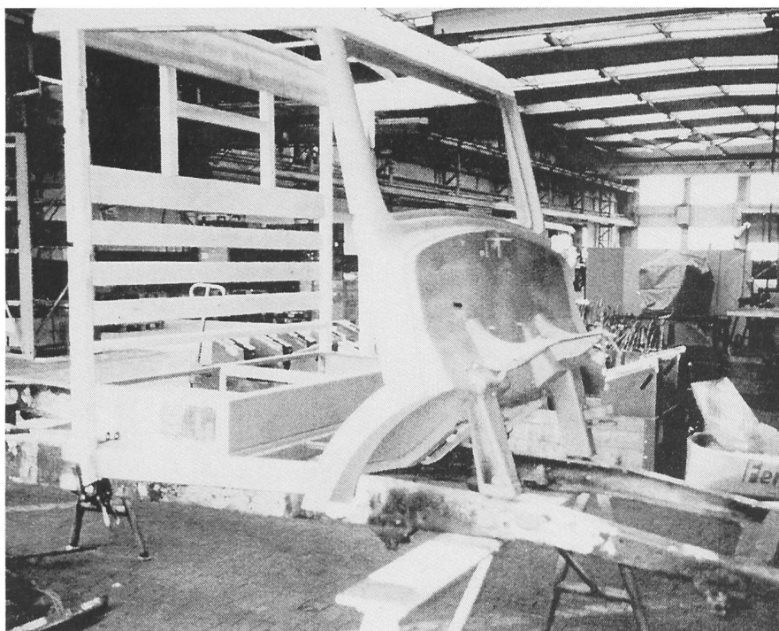
Holzgerippe der Kabinenrückwand im Neuaufbau
