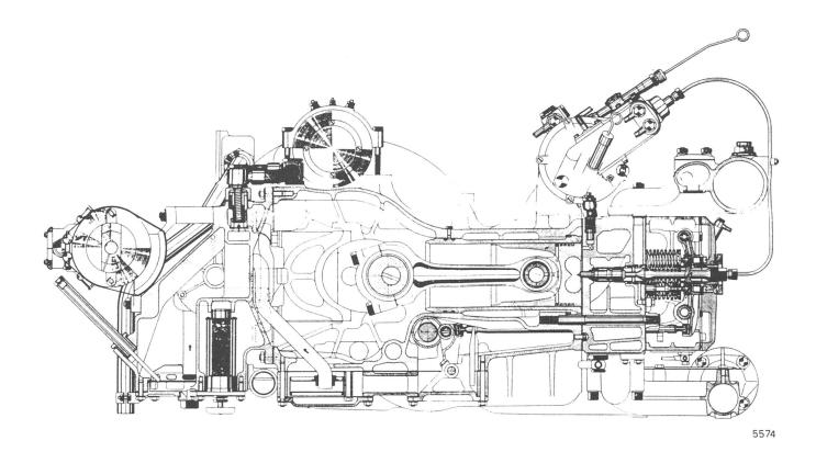
Abb. 10 Querschnitt durch den Unterflurmotor
