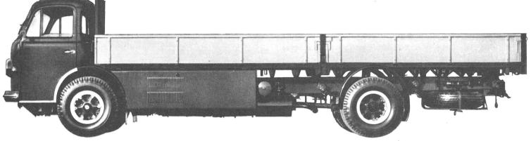
Die vor der Vorderachse aufgebaute Kabine und der horizontale Dieselmotor lassen die grösste Länge der Ladebrücke zu, sie ergeben ideale Verhältnisse für den Transport von Sperrgut.
