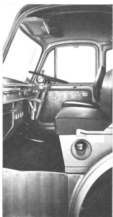
Die geräumige 4plätzige Kabine ist durch breite Einstiege leicht zugänglich. Der abgefederte und hydraulisch gedämpfte Fahrersitz ist in allen Richtungen verstellbar. Als Schlafgelegenheit für 2 Personen dient die nach vorn abklappbare Sitzbank. Besonders angenehm fällt die geräuscharme Fahrweise auf.
