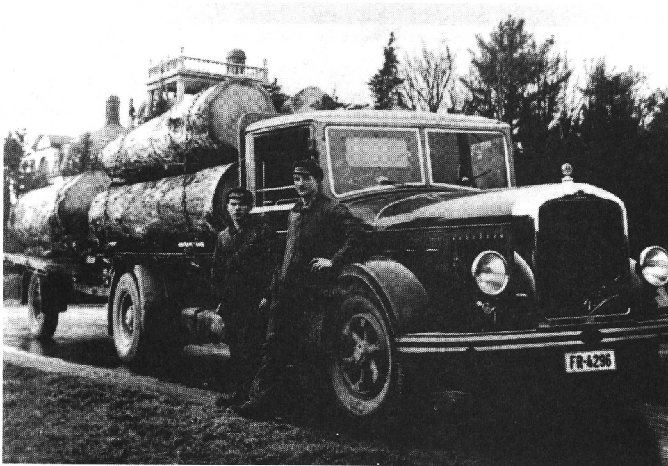
Bild 3: mit Kippbrücke und Einachsanhänger für Holztransporte
