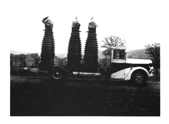
Bild 11: der FR 4296 als « Tieflader » für Isolatorentransporte
