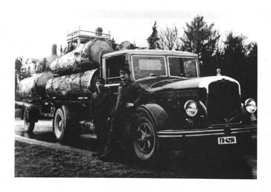
Bild 3: mit Kippbrücke und Einachsanhänger für Holztransporte
