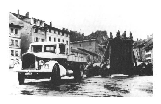
Bild 9: als Kipper + Holzrädertieflader mit Elektro-Transformer
