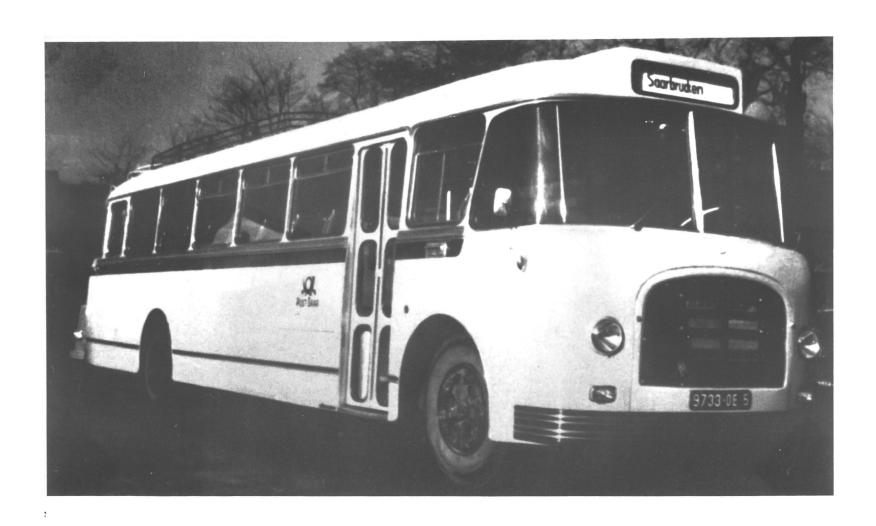
Saurer 4C Motor CT 3 D mit 130 PS. Sonderaufbau für die Post des damals autonomen Saarlandes.
