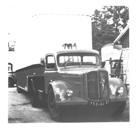
Bild unten: Saurer 3C Motor CT 1 D mit 100 PS, Aufbau Carel+Fouchet.
