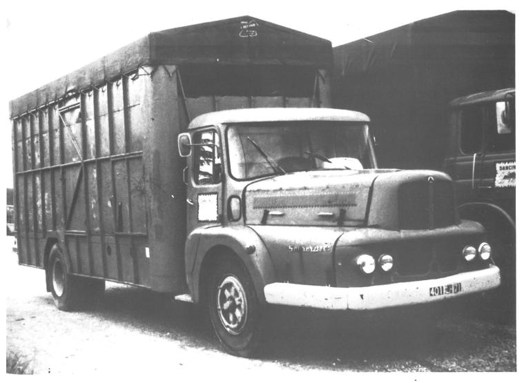
Bild oben: Saurer/Unic Z 59 L, Baujahr 1959, Motor CT 3 D mit 130 PS.
