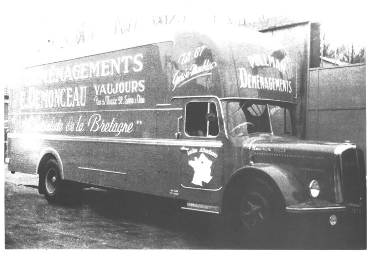
Bild oben: Saurer 3C Motor CT 1 D, Baujahr 1953/54 mit Pepel-Aufbau Bild unten: Saurer 3C Motor CT 3 D, Baujahr 1953, Carrosserie von Pepel in Rennes. 34 Sitzplätze.
