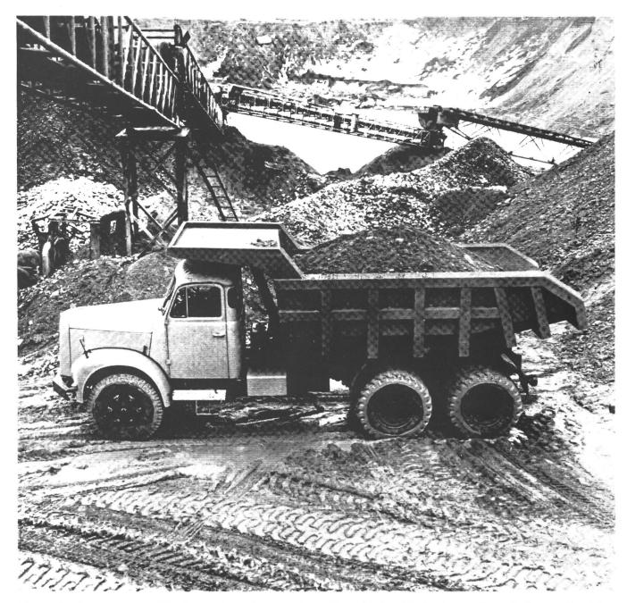
Unter der Bezeichnung 5 D 6×4 bietet Saurer ein dreiachsiges Fahrzeug an, das für höchste Ansprüche gebaut ist Die Bezeichnung 5 D 6×4 bedeutet, dass dieser Wagen vom bewahrten Typ 5 D abgeleitet ist, jedoch sechs Rader hat, von denen vier angetrieben sind
