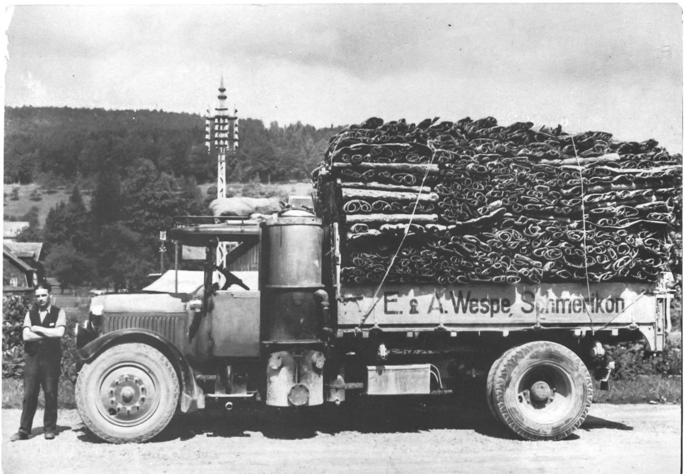
Bild oben. Links FBW L40 mit 90-100 PS. Besitzer Hanhard Diessenhofen. Rechts Berna 6-Zyl. Jahrg. 1936 mit CTD Motor, 85 PS. Besitzer Sepp Wespe sen. auf der Rückfahrt Schwarzwald- Schweiz 1946, Spitze 35 Std./Km, Pneu geschmuggelt! Bild unten. A-Wagen während dem Krieg beladen mit Baumrinde. Besonderes: Fahrzeug mit Imbert Holzvergaser.
