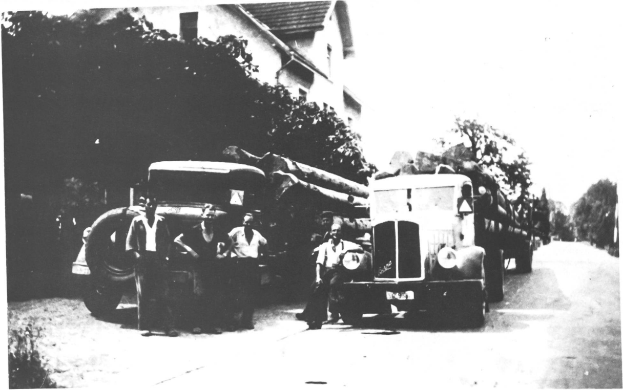
Bild oben. Links FBW L40 mit 90-100 PS. Besitzer Hanhard Diessenhofen. Rechts Berna 6-Zyl. Jahrg. 1936 mit CTD Motor, 85PS. Besitzer Sepp Wespe sen. auf der Rückfahrt Schwarzwald- Schweiz 1946, Spitze 35Std./Km, Pneu geschmuggelt! Bild unten. A-Wagen während dem Krieg beladen mit Baumrinde. Besonderes: Fahrzeug mit Imbert Holzvergaser.
