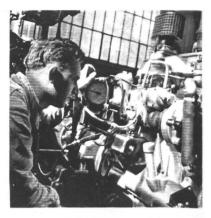
Prüfstand: Jeder Motor wird vor seiner Ablieferung genau auf mechanische Fehler der Herstellung, Leistung und Verbrauch geprüft.
