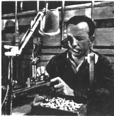
Düsenfabrikation: Diese Bohrmaschine bohrt Löcher von 0,25 mm Durchmesser in die Spitze der Einspritzdüsen für Dieselmotoren.
