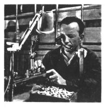
Düsenfabrikation: Diese Bohrmaschine bohrt Löcher von 0,25 mm Durchmesser in die Spitze der Einspritzdüsen für Dieselmotoren.
