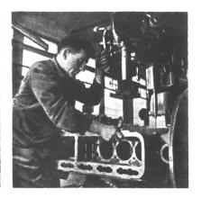
Bohrmaschine: Auf ihr werden nach Bohrlehren oder nach vom Anreisser gezeichneten Stellen mit grösster Präzision Löcher gebohrt oder Gewinde geschnitten.
