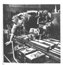
Fräse: Die fehlerfreie und masshaltige Bearbeitung des Werkstücks ist das Erzeugnis guter Werkzeugmaschinen, welche unter der Aufsicht qualifizierter Arbeitskräfte stehen.
