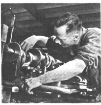
Drehbank: Eine Kurbelwelle, aus bestem Stahl geschmiedet, muss zuverlässig auf Hundertstelmillimeter Genauigkeit bearbeitet werden.
