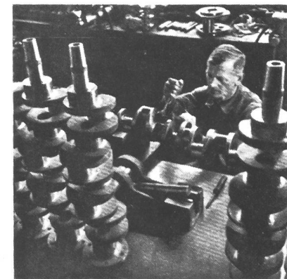
Kurbelwellen: Die Kurbelwellen werden sorgfältig auf ihre Masse kontrolliert und mit den Leitungen für die Ölzirkulation versehen.
