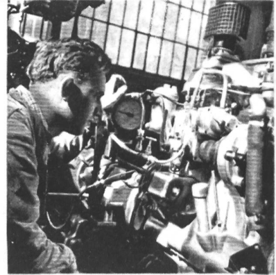
Prüfstand: Jeder Motor wird vor seiner Ablieferung genau auf mechanische Fehler der Herstellung, Leistung und Verbrauch geprüft.
