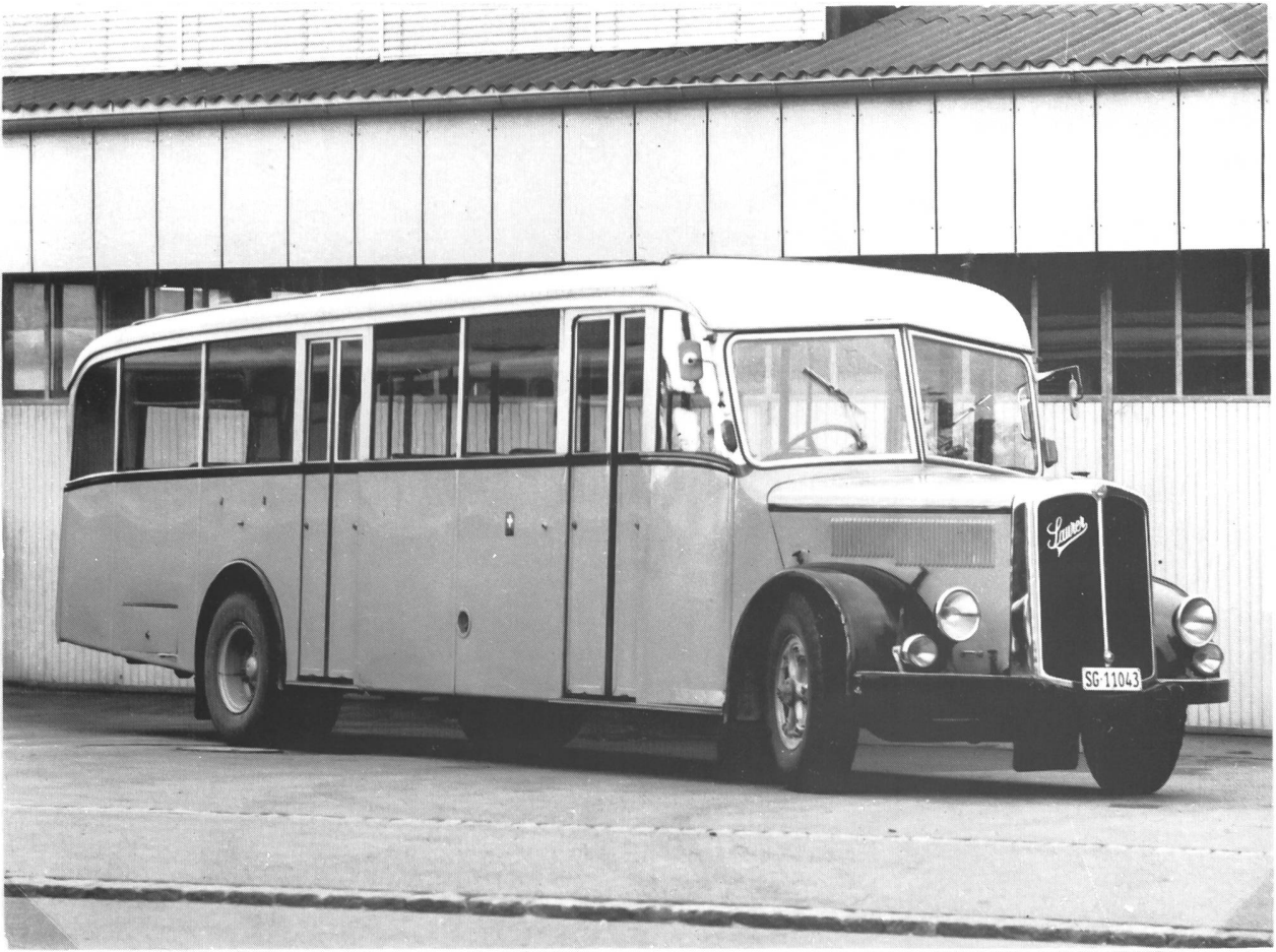
Saurer L4C Jahrgang 1946 mit Druckluft-Türen.
