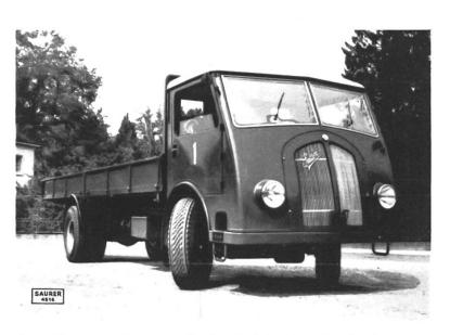
S4C-H-Lastwagen für ca. 7 t Nutzlast, Radstand 5 m, Brücken-Innenlänge  $7\,\mathrm{m}$ , Wendekreis 15 m.
