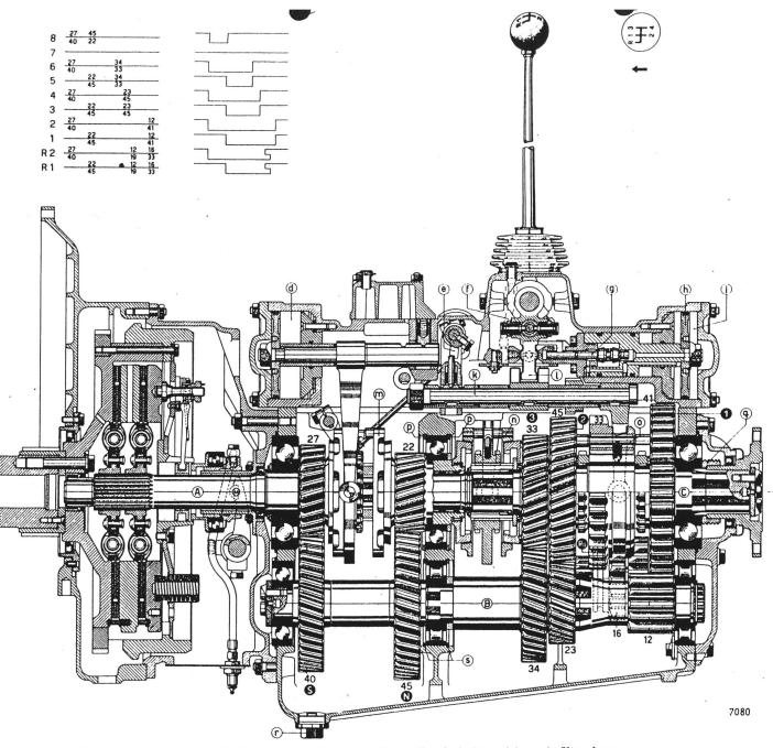
Schnitt durch das Achtgang-Servo-Handschaltgetriebe mit Kupplung
