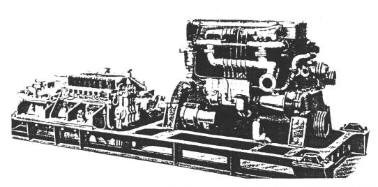
Abb. 4. Motor-Getriebe-Aggregat, auf dem sog. Maschinenrahmen montiert (die elektro-pneumatischen Ventile des Stufengetriebes sind normalerweise verschalt)
