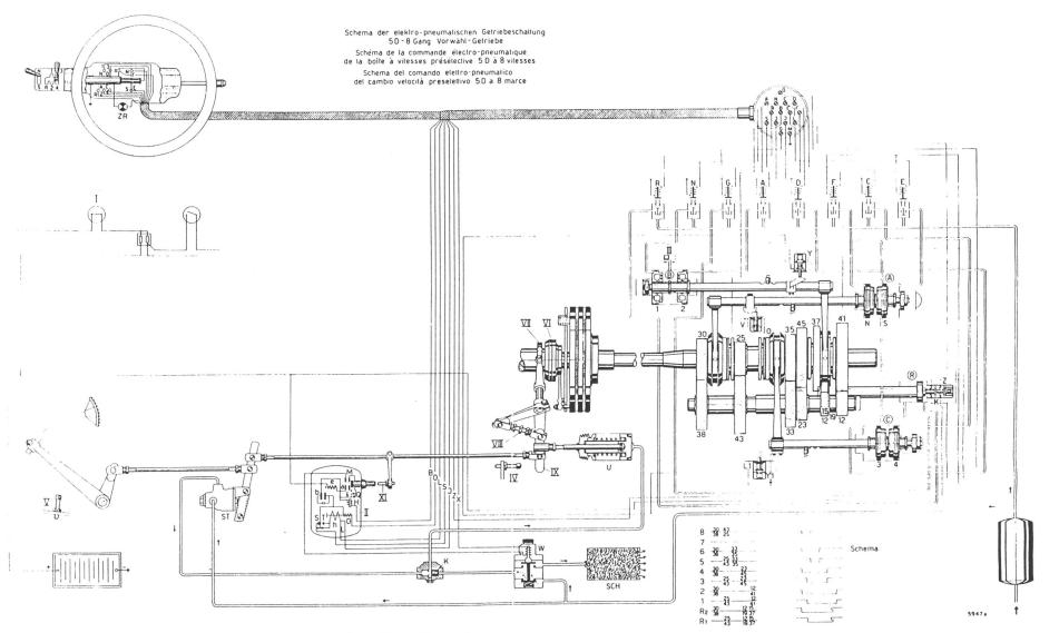
Abb. 48 Schaltschema des 5D-8 Gang-Vorwählgetriebes
