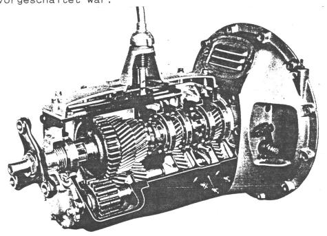
Abb. 3 Schnitt durch das 8-Gang-Getriebe
