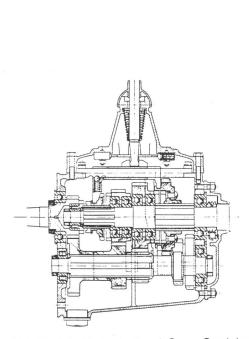
Abb. 2 Schnitt durch das 4-Gang-Getriebe
