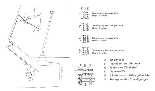
Abb. 4 Schematische Darstellung der Schnellgangschaltung
