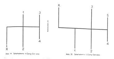
Zu einem späteren Zeitpunkt wurde das Getriebe überarbeitet und schaltfreundlicher konstruiert. Der 4. und 5. Gang wurden synchronisiert. Das Schaltbild entsprach nun dem heutigen Usus.
