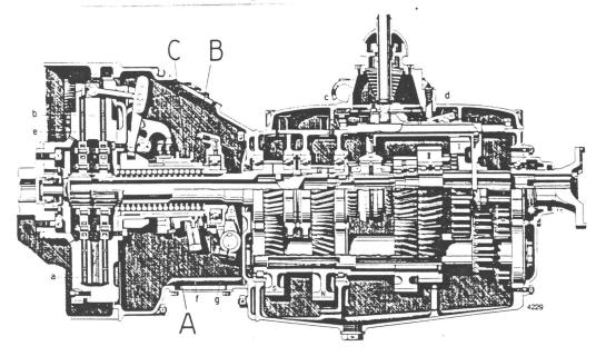
Abb. 41 Schnitt durch Doppelkupplung und 8-Gang-Getriebe
