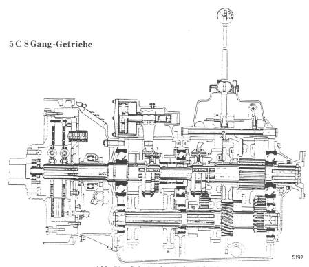
Abb. 70 Schnitt durch das 5 C-8 Gang-Getriebe und Zweischeibenkupplung
