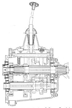
Abb. 3 Schnitt durch das 5-Gang-Getriebe
