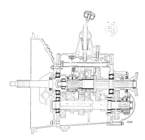
Abb. 53 Schnitt durch das 5-Gang-Getriebe
