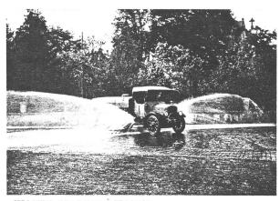
ARROSEUSE AVEC DOMPE À PRESCION. SPRENGWAGEN MIT PUMPE. WATERING WAGON WITH FUMP.
